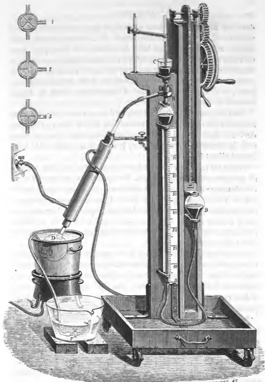
Fig. 16. — Pompe à mercure disposée pour l'extraction des gaz du sang.
