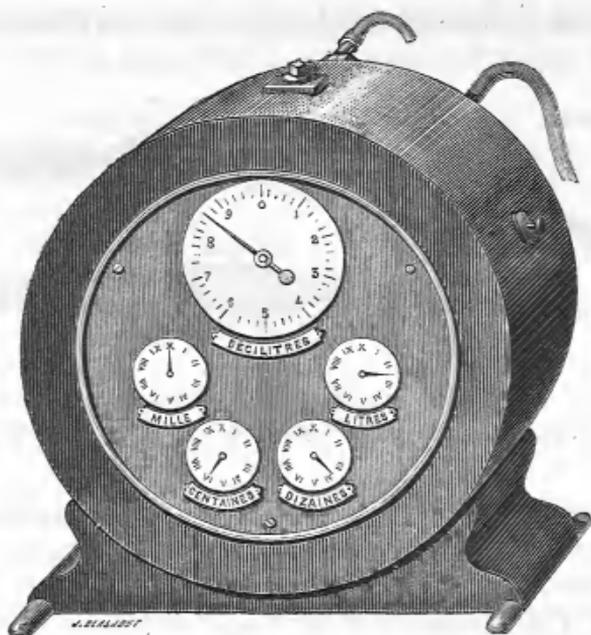
Fig. 65. — Compteur à gaz pour la mesure des mouvements respiratoires.
