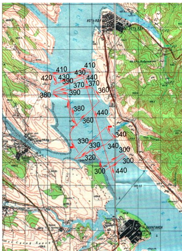
Рис. 3. Схема поперечных профилей НСП в пределах участка работ. Fig. 3. Continuous seismic profiling (CSP) scheme of the study area.
