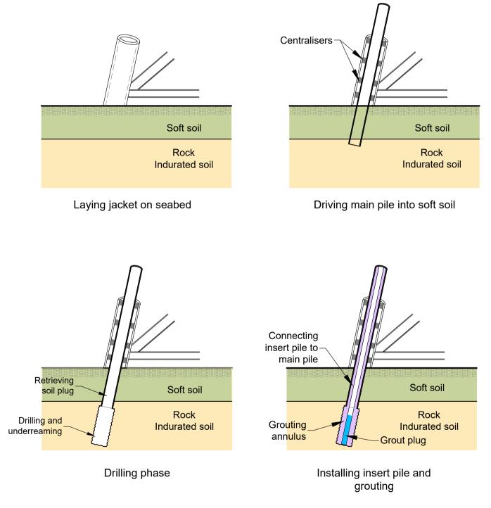
Figure 9.5: Diagram of implementation of an « insert » pile
