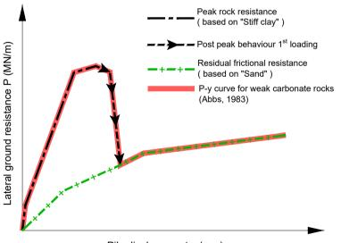
Pile displacement y (mm)
