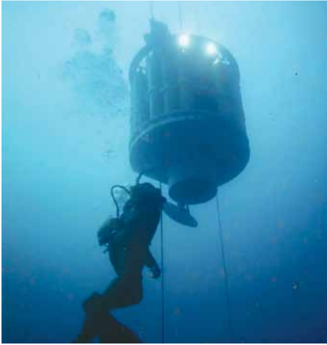
Les tourelles de plongée, développées à partir des années 60 (ci-contre), ont permis aux plongeurs professionnels de repousser les limites du temps et de gagner en productivité et en efficacité sur les chantiers profonds.
