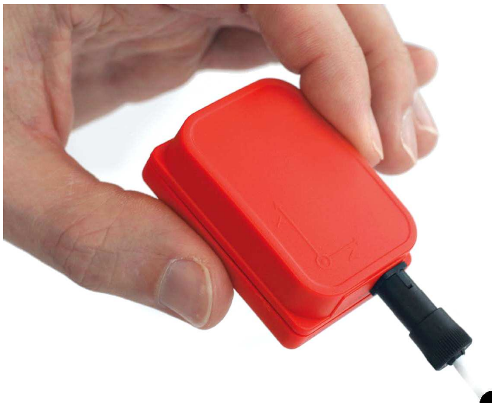
FIGURE 1.24 – La centrale inertielle MTx de Xsens .
