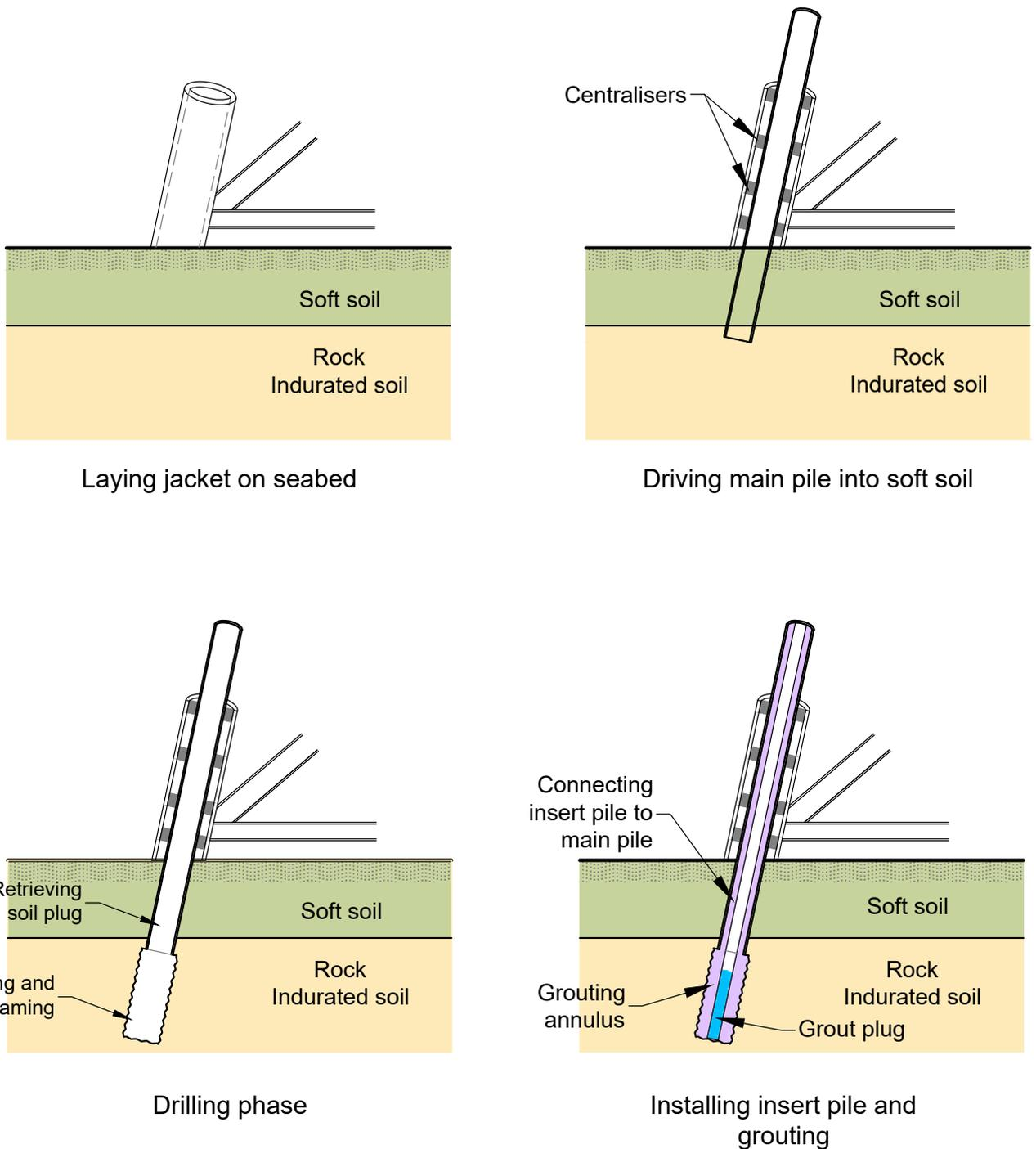
Figure 9.5: Diagram of implementation of an « insert » pile
